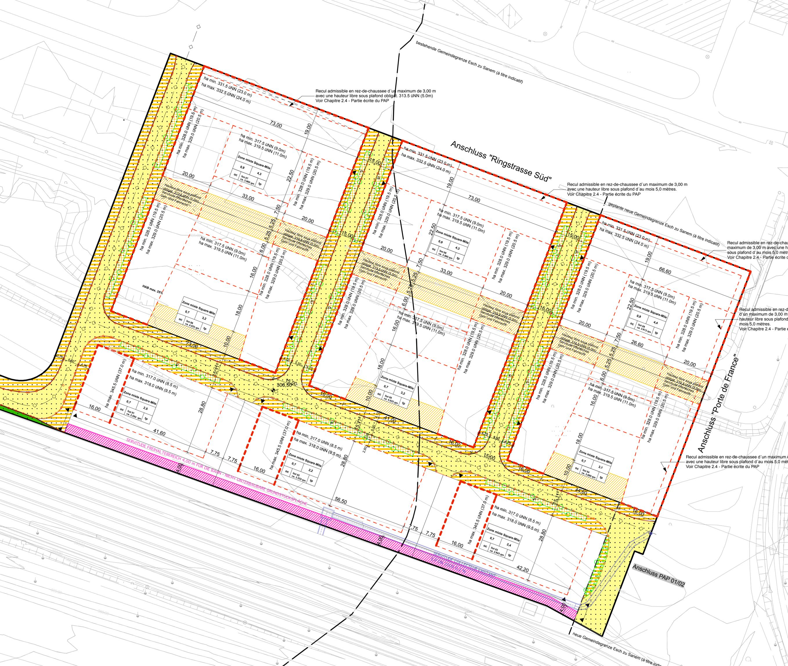
Recul admissible en rez-de-chaussee d'un maximum de 3,00 m avec une hauteur libre sous plafond obligat. 313,5 uNN (5,0m)
