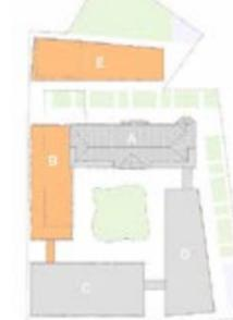
Abbruch Bestand Gebäude B und E, Neubau Gebäude B und E mit Anbindung an Gebäude C.
