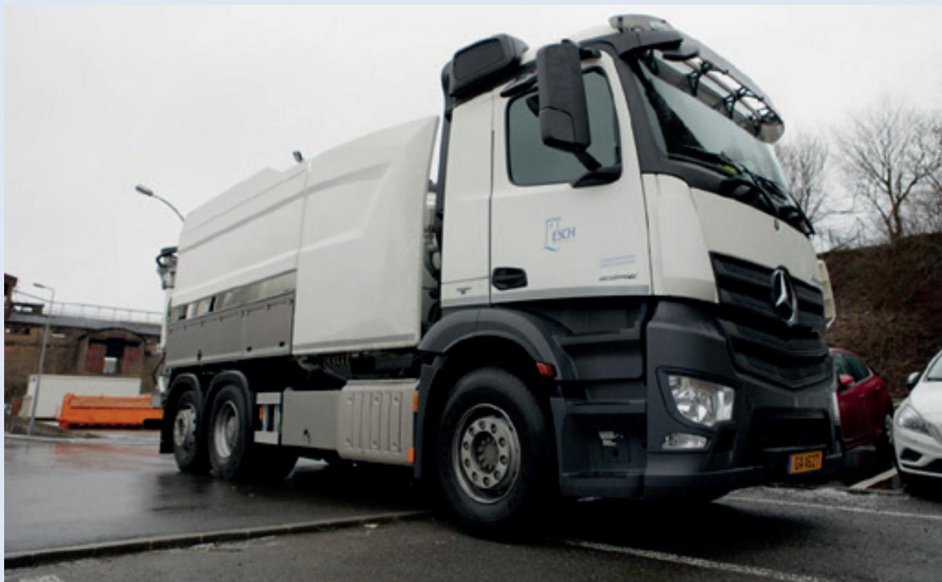
Ce système, ultramoderne, est doté d'un mécanisme de recyclage qui permet de séparer l'eau des matières solides aspirées dans les canalisations. L'eau ainsi collectée est à son tour réinjectée dans la canalisation pour rincer les tuyauteries. Montée
