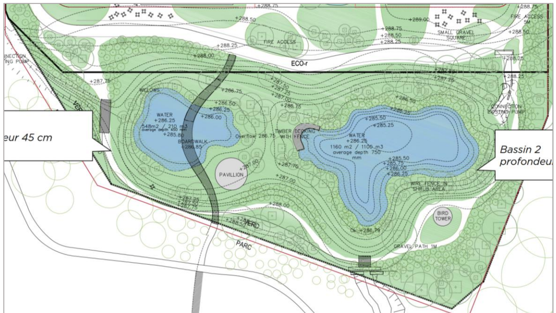
Abbildung 23 Konzept zur Umgestaltung des Retentionsbeckens
